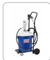
Fedtsystem pneumatisk til stortønder 25 kg, transportabel • Pneumatisk smørepumpe 1:55 med suge- og pumpestation • flow: 600 cm 3 /min • højtryksfedt-pistol med z-drejeled • støvlåg, beholderbeslag og fedtmedløberpladen • trykreduktionsventil og stik • kørevogn • 4 m højtryksslange
